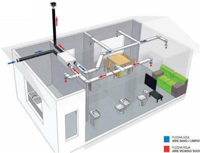
La **ventilación de doble flujo** es un sistema que asegura la Calidad de Aire, a través de la extracción del aire viciado en las estancias húmedas (cocina, baños, aseos, lavaderos, ...) y que simultáneamente asegura la insuflación de aire nuevo filtrado en las estancias secas (salón, comedor, dormitorios,...).
